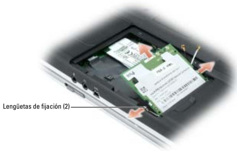
**AVISO:** Los conectores tienen la forma adecuada para garantizar que la inserción es correcta. Si nota resistencia, compruebe los conectores y vuelva a alinear la tarjeta.
