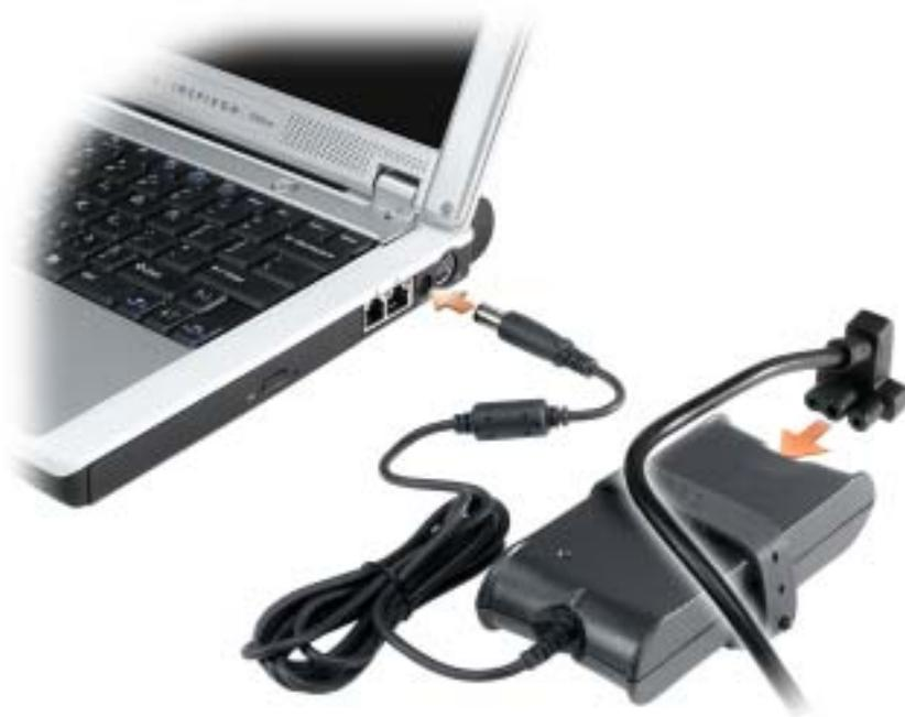
El adaptador de CA convierte la corriente alterna en la corriente continua que necesita el equipo. Puede conectar el adaptador de CA al equipo independientemente de que esté encendido o apagado.
